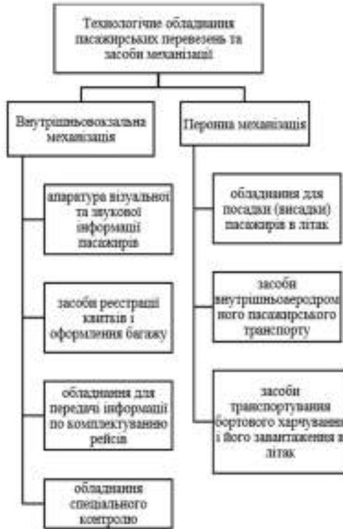
Рис. 2. Технологічне обладнання пасажирських перевезень та засоби механізації
