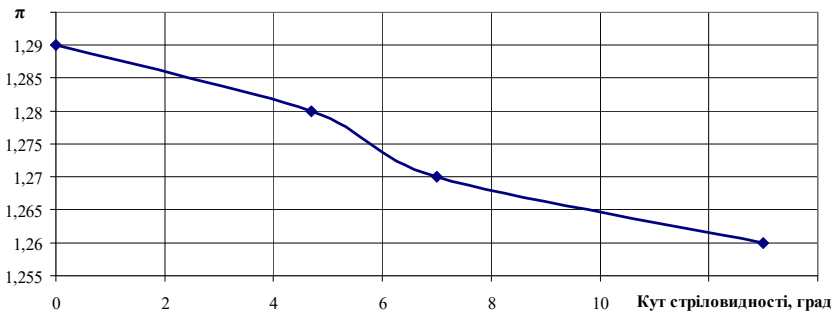
Рис. 1. Залежність кута стріловидності передньої кромки лопаток вентилятора від ступеня підвищення тиску у вентиляторі \pi
